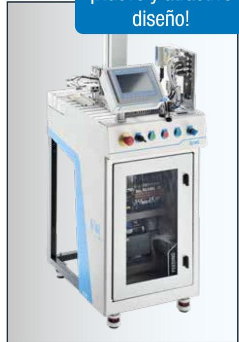
Cada estación integra DOS CONTROLADORES, uno en el armario principal para el control de la estación y otro ubicado en el módulo de transporte. Cabe destacar la autonomía del sistema de transporte, que al integrar un PLC permite su operación como un conjunto independiente simplemente conectándolo a una fuente de alimentación.
