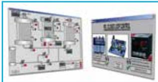
Il s'agit d'une application software d'utilisation standardisée dans l'industrie, qui permet de réaliser une supervision et un contrôle du procédé depuis l'écran de l'ordinateur.
